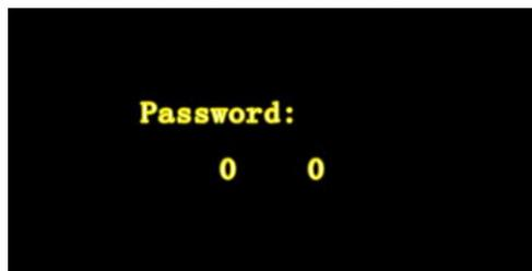
两位数字代表密码。最后一位数闪烁时，使用“↑”更改数字(0 ~ 9);按“设置”键选择要更改的数字。第一个数字闪烁时，使用“↑”更改数字(0 ~ 9)，默认密码为“99”。输入正确的密码后，就可以开始设置控制器了。
